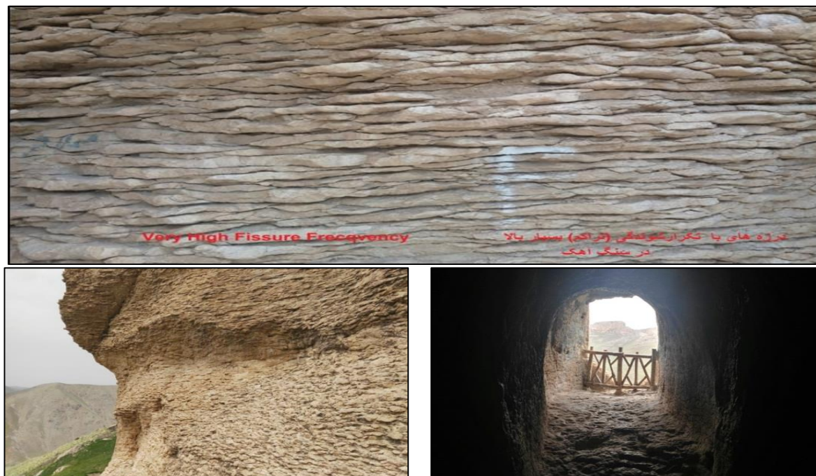
شکل ۸. شبکه درزه‌های بسیار متراکم ناشی از گسلش واحد آهکی f در دیواره بیرونی و داخل غار
